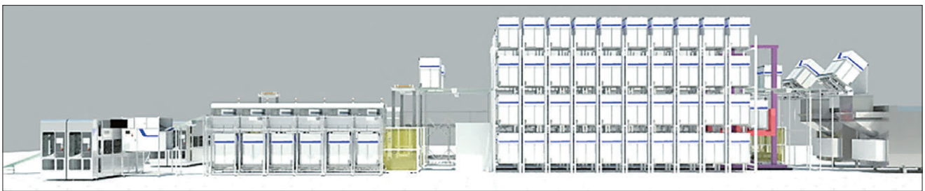
図2 連続洗濯機2台の使用例
